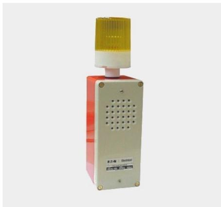
Alarme audiovisual para telefone que sinalizam o toque do telefone em áreas ruidosas ou distantes onde o mesmo não é ouvido em condições normais. Conectadas em paralelo com a linha telefônica, são acionados simultaneamente, disparando uma sirene com o som característico de telefone e um sinal luminoso a cada toque. Ao atender o telefone, desliga-se automaticamente.
